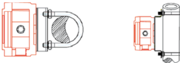
图18:管道支架安装图
